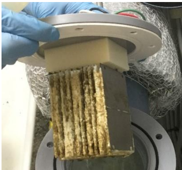
図 2 カルシウムが析出した電極
