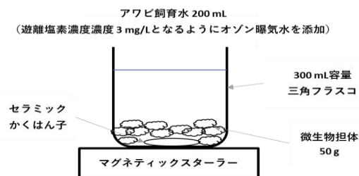
図5 担体付着微生物の有無による遊離塩素除去効率検証試験の模式図
