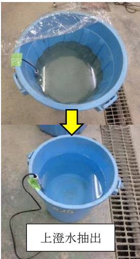
写真-1 スラッジ水
