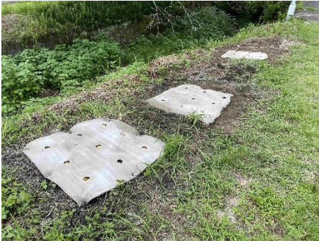
図-7 CASE2 削孔による掘り起こし誘発
