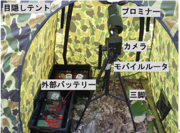
写真-1 本カメラシステムの設置状況
