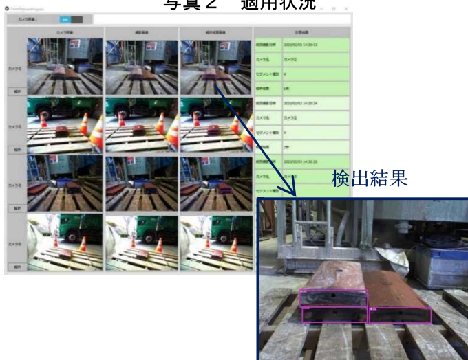
図3 画像解析によるセグメントの検出結果
