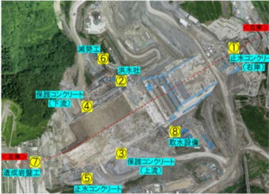
図-1 コンクリート打設箇所
