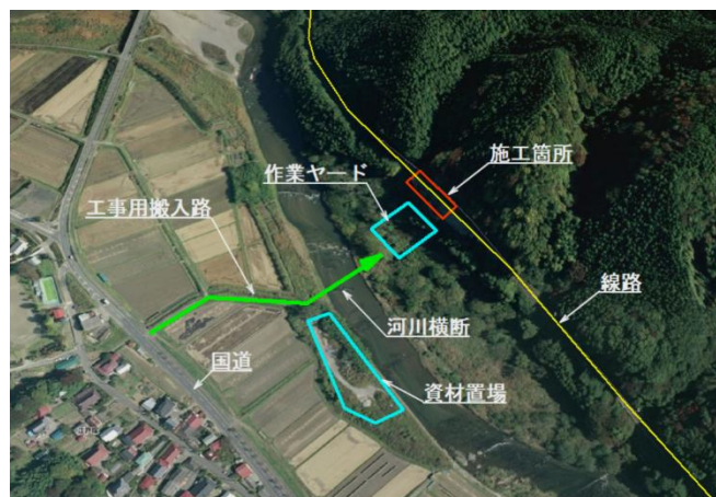
図-4 工事用搬入路
