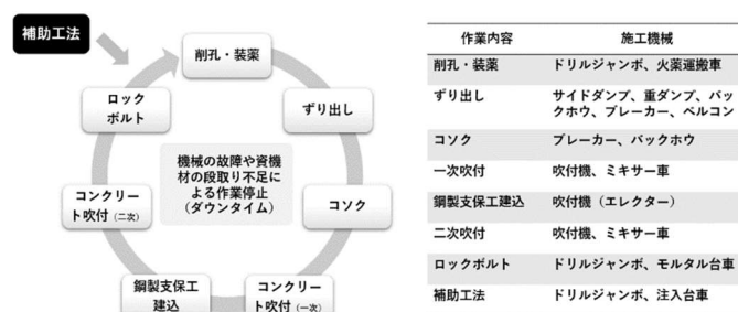
図1 掘削サイクルと施工機械
