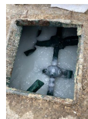
写真-2 左:ハイドロシーダ, 右:タンク内攪拌機
