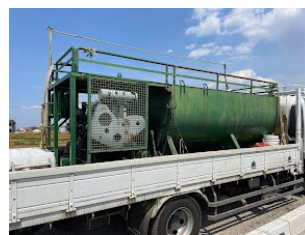
写真-2 左:ハイドロシーダ, 右:タンク内攪拌機
