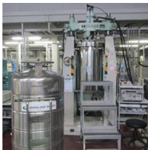
写真-1 液化ヘリウム浸漬環境試験装置
