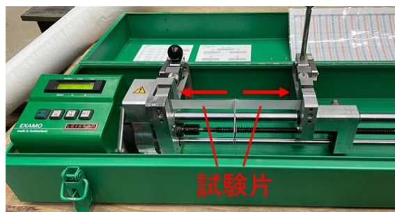
写真-3 溶着部試験片の引張強度試験状況
