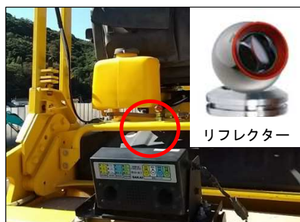
写真-2 リフレクター設置状況
