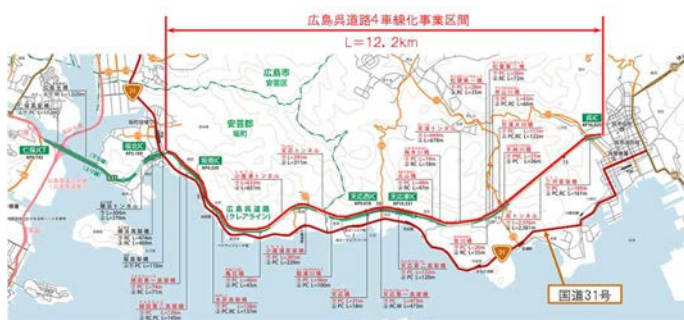
図-1 広島呉道路4車線化事業
