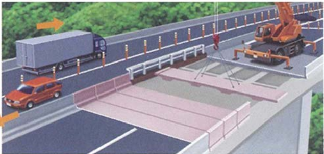
図－1 橋梁の床版取替工事イメージ
