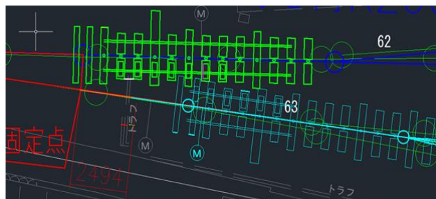
【図2】分岐マクラギ配置図
