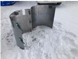
<養生鋼板 (展開状況)>
