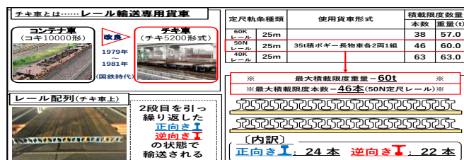
図-1 「チキ車の概要(レール配列と積載重量・本数)」
