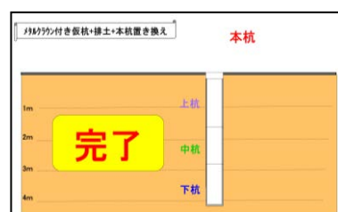
図-10 基礎杭打設完了
