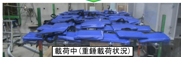
図 3 静的載荷 試験状況
