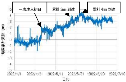
図-3 側壁④鉛直累計変位 経時変化図
