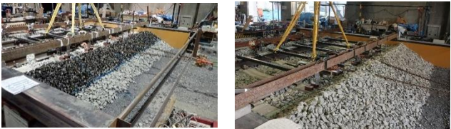
図 2 軌きょう引き試験の状況
