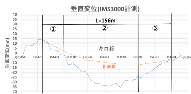
図4 IMS3000計測による垂直変位及び計画線
