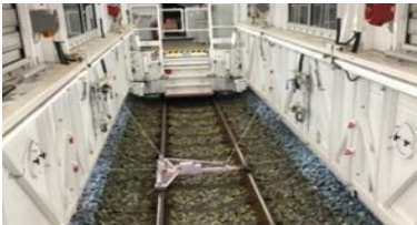
写真-5 軌道変位測定検証
