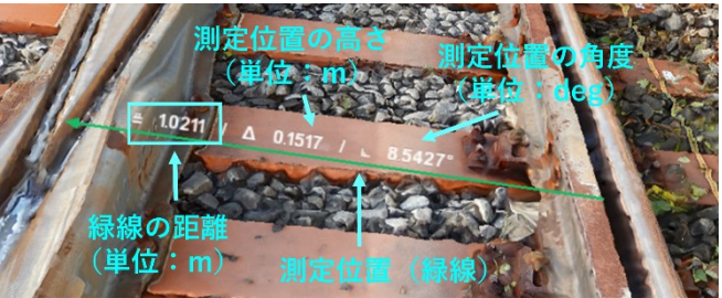
図4 3次元モデル上の寸法測定例（バックゲージ）
