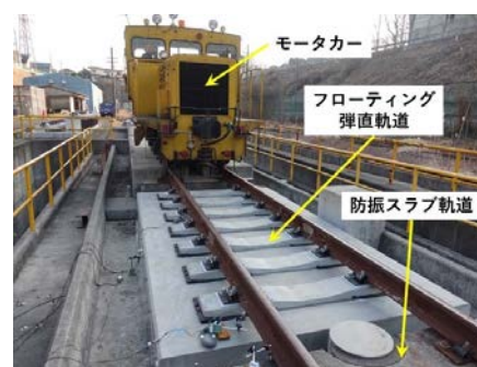
図 6 モーターカー走行試験の様子
