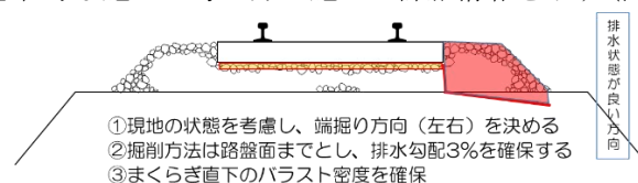
図2 基本的な施工の考え方と施工イメージ図
