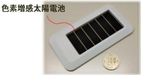
図-3 バッテリーレスビーコンの外観
