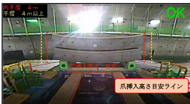
図 - 7 モニター表示画面例 (フォーク挿入高さ調整用カメラ映像)
