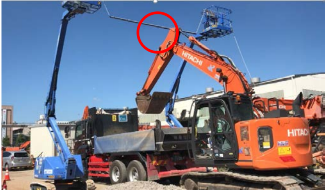
図-3 トンネル覆工への接触防止を目的としたダンプトラックへの積込み性能確認試験
