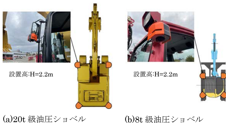
図3 カメラの取り付け状況
