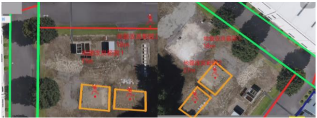
図-5 前進、後退による AR 表示 (偏角補正あり) 図-6 旋回移動による AR 表示 (偏角補正あり)
