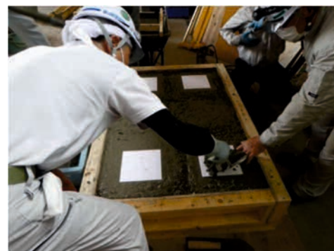
写真-2 供試体作成状況
