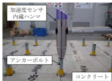
写真-1 打撃試験の状況
