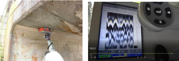
電磁波レーダー法 かぶり厚さ結果 写真-2 配筋状況、かぶり厚さ測定状況
