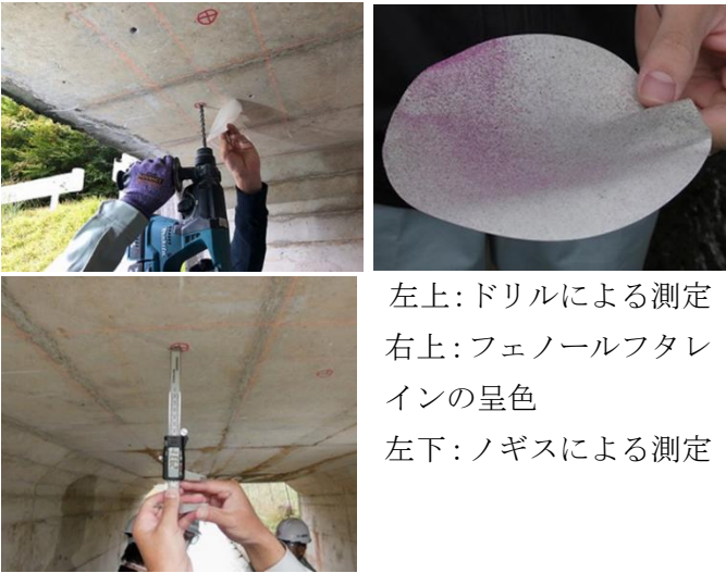
写真-1 中性化深さの測定方法
