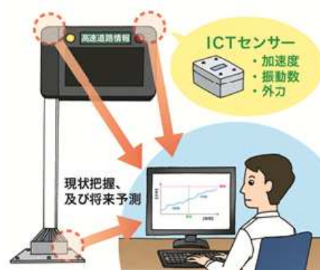
図-1 疲労監視システムの運用
