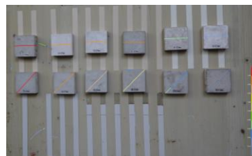
写真-4 ひび割れ検出結果
