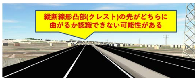
図-6 3次元モデルによる平面・縦断線形の位相確認
