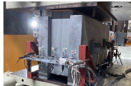
図 7 継手せん断試験状況
