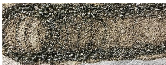
b) 出力：3kW，エネルギー密度：低
