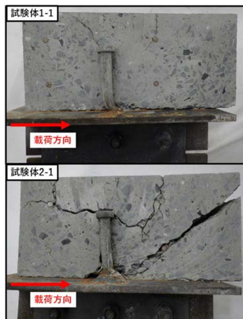
図-5 試験体切断面の比較
