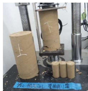
写真-3 一軸圧縮試験状況
