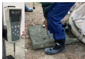
写真-6 ペネトレーション試験
