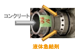
写真-4 シャワーリング
