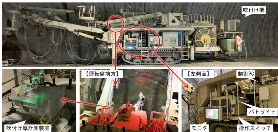
図-7 吹付け機への機器搭載例（FTS 社製ヘラクレス）
