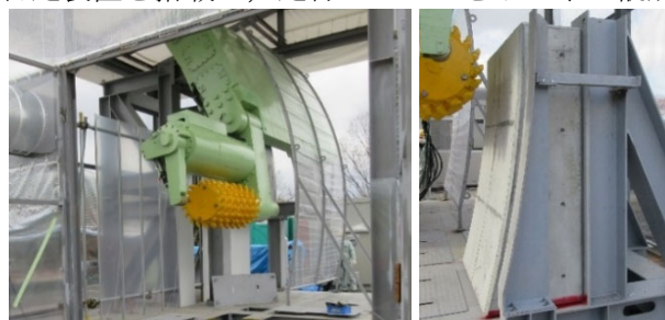
図-2 試験用切削装置と切削用供試体の全景
