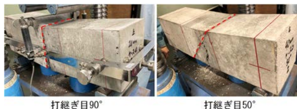
図-6 曲げ試験後写真
