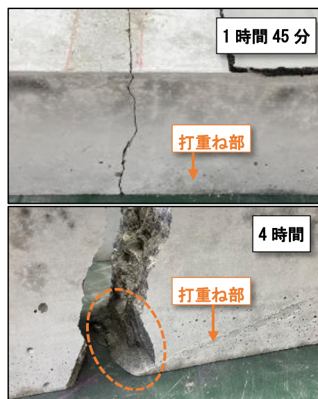
写真-1 供試体破壊状況
