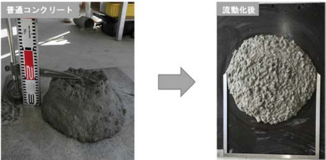
写真-1 流動化前後のコンクリートの外観
