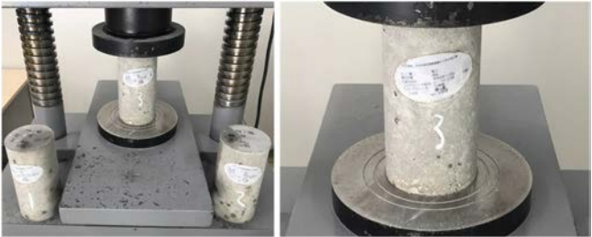
写真-2 打ち重ね供試体の外観
