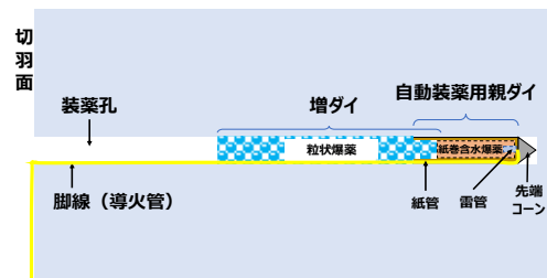
図-2 自動装薬模式図
