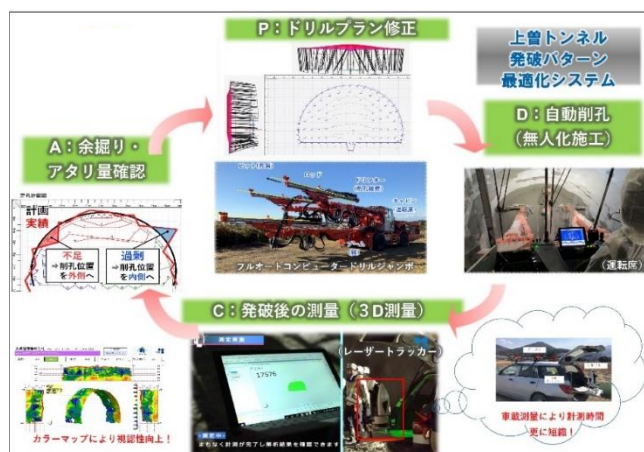
図-2 発破パターン最適化サイクル
