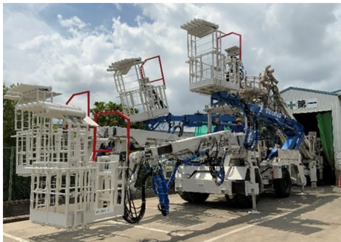
図-1 開発した4ブーム式装薬台車の全景
